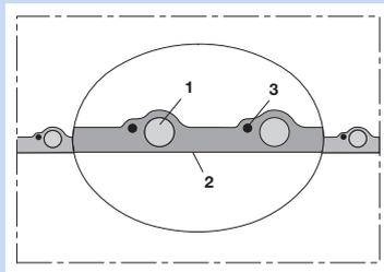
Antistatischer Absaug- und Förderschlauch; schwer, innen glatt, ca.  $10^9 \Omega$ , Erdungslitze
